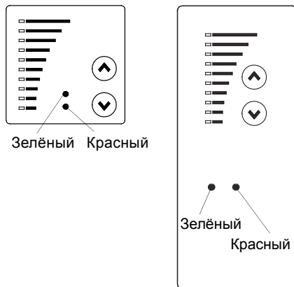
Рис. 28 Световые индикаторы на панелях управления одно- и трехфазных насосов
